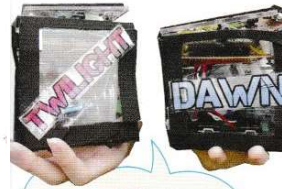
これが自分たちで作った衛星。気候データを取り、映像を記録します。
